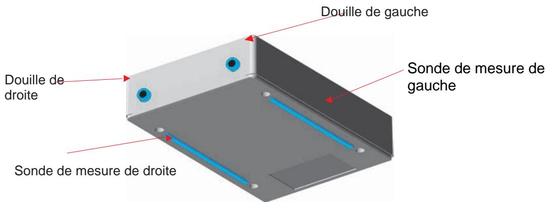
« Douille de droite » et « Sonde de mesure de droite ».
